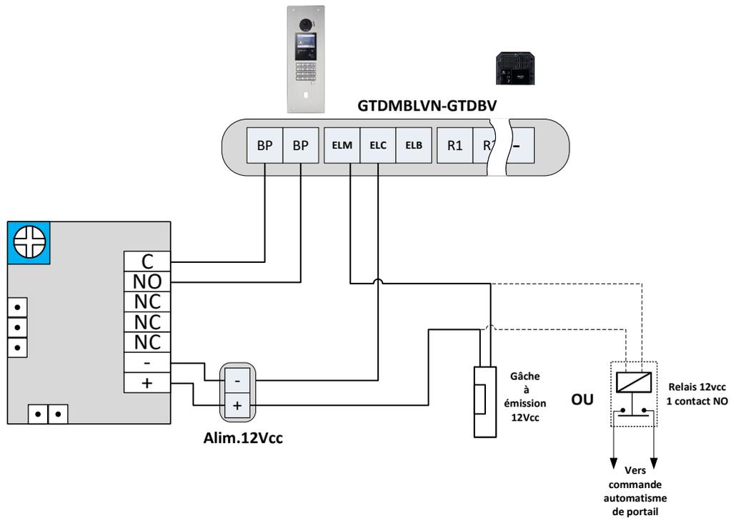
**Exemple pris pour un câblage 12Vcc mais le BP60LA peut être alimenté de 12V à 24VAC/DC**
