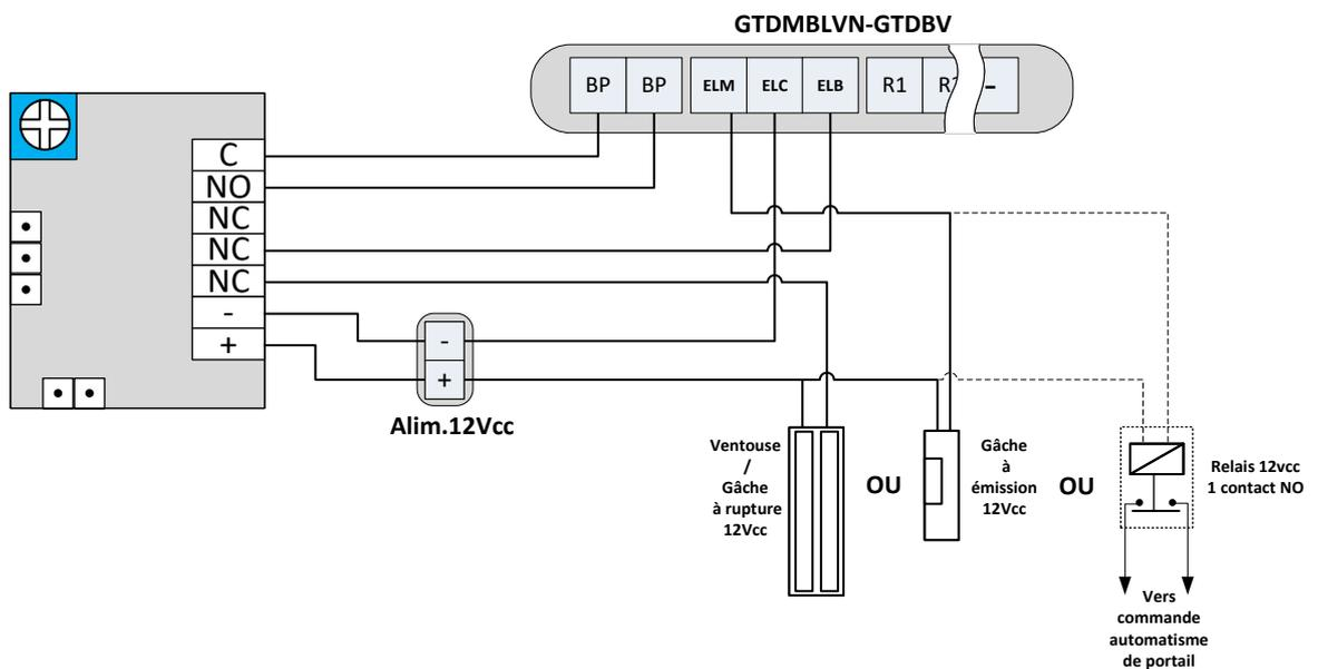
***Exemple pris pour un câblage 12Vcc mais le BP60LA peut être alimenté de 12V à 24VAC/DC***
