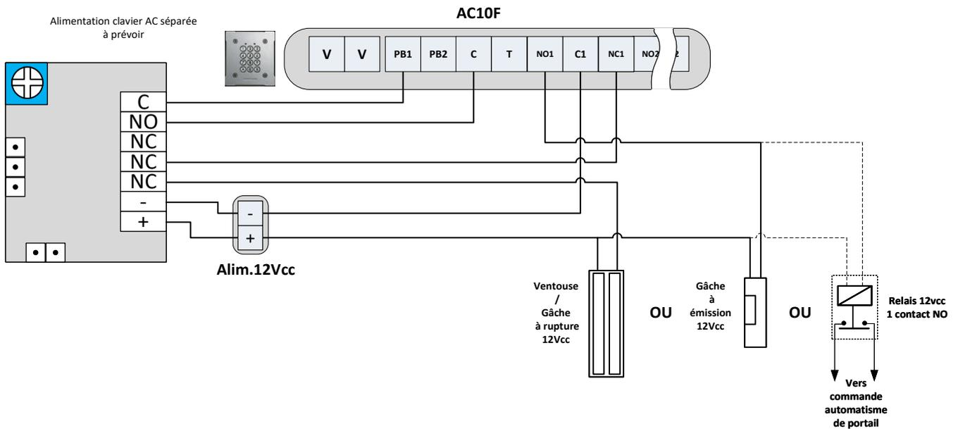
***Exemple pris pour un câblage 12Vcc mais le BP60LA peut être alimenté de 12V à 24VAC/DC***
