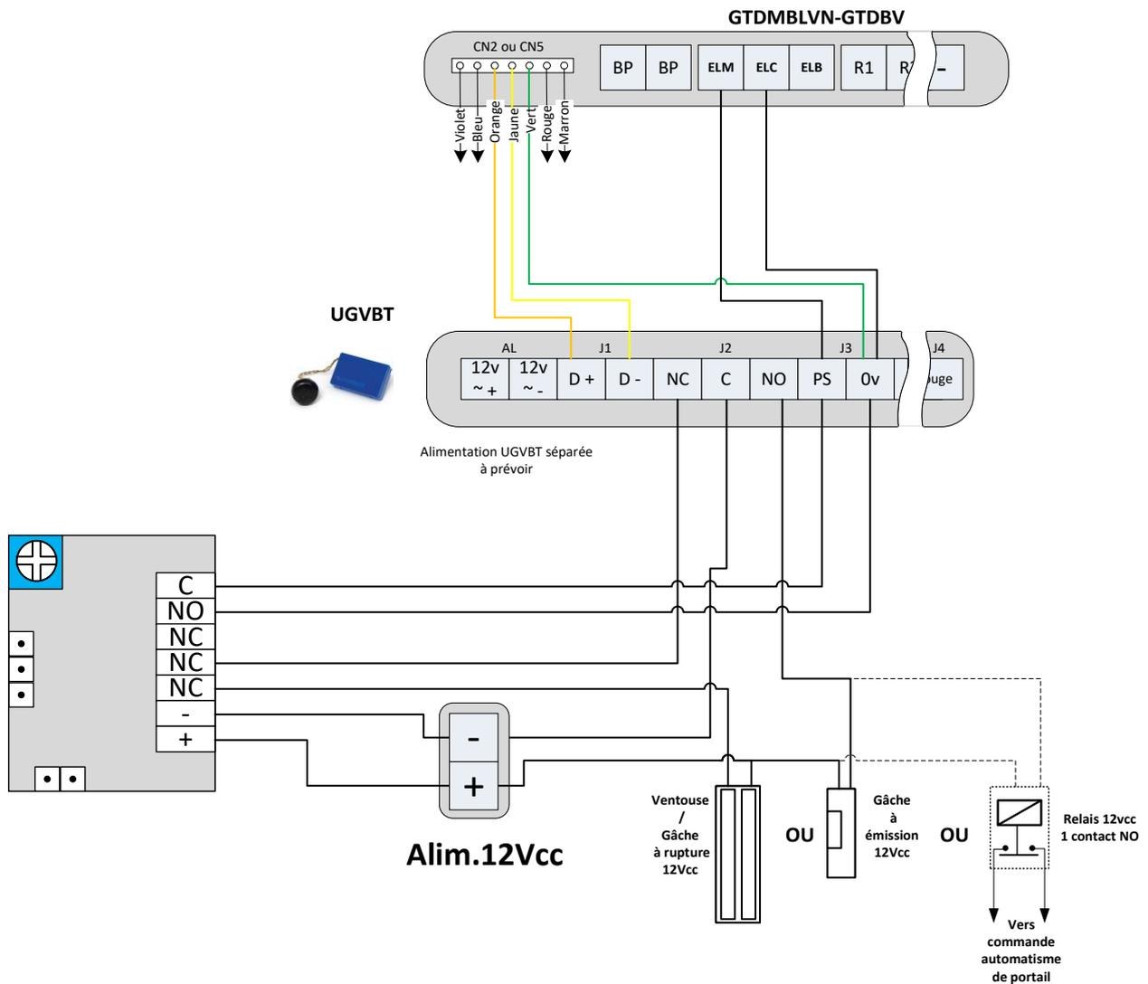
***Exemple pris pour un câblage 12Vcc mais le BP60LA peut être alimenté de 12V à 24VAC/DC***
