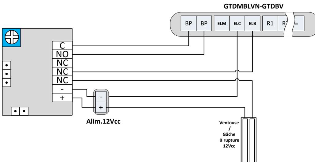
***Exemple pris pour un câblage 12Vcc mais le BP60LA peut être alimenté de 12V à 24VAC/DC***
