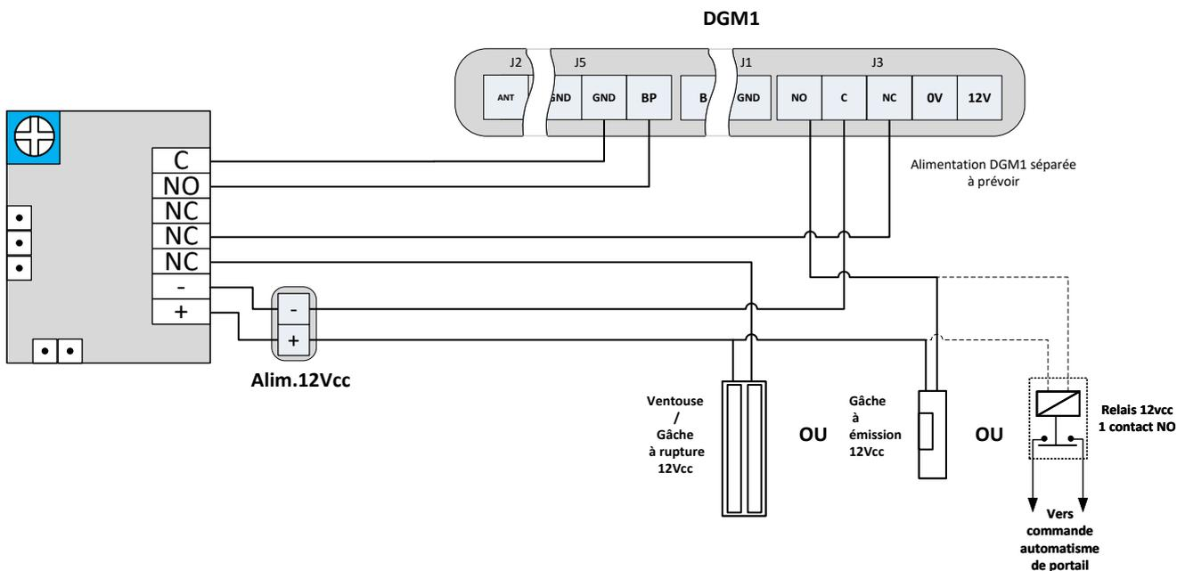
***Exemple pris pour un câblage 12Vcc mais le BP60LA peut être alimenté de 12V à 24VAC/DC***
