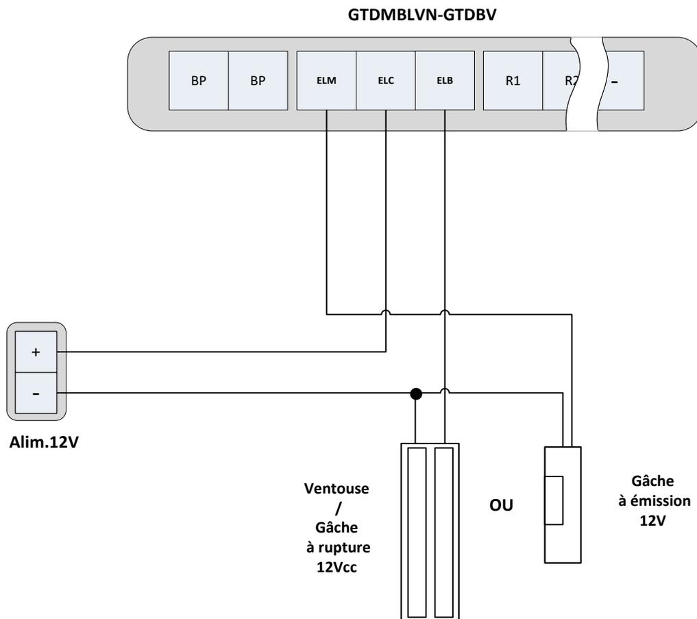
**Exemple pris pour un câblage 12Vcc mais le BP60LA peut être alimenté de 12V à 24VAC/DC**
