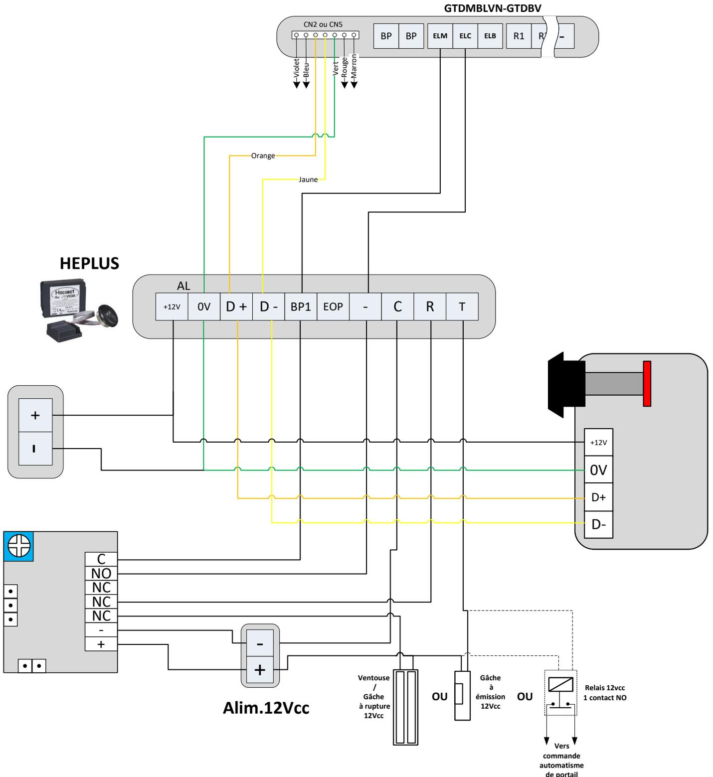
***Exemple pris pour un câblage 12Vcc mais le BP60LA peut être alimenté de 12V à 24VAC/DC***
